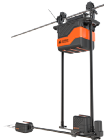
10KV/110KV架空线路树障清除机器人
